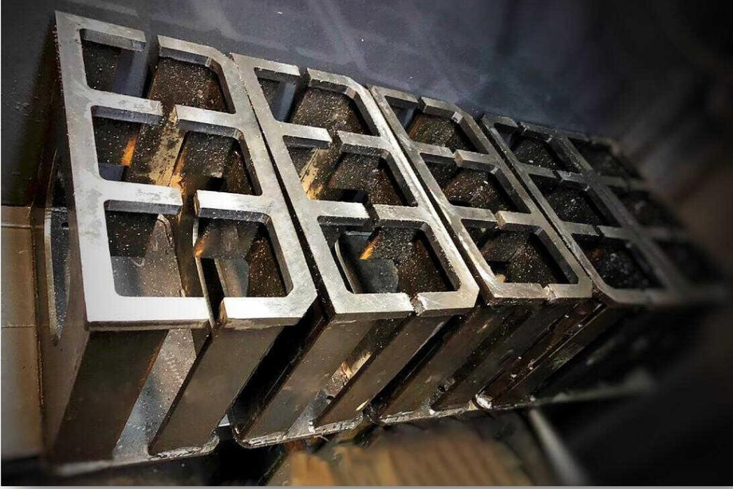
عند صنع القوالب التي يتعدى ارتفاعها 12 سم فإن المعيار المستخدم لذلك هو قالب ST 52-3/A1 . كخيار آخر، يمكن تصنيعها باستخدام مواد خام ذات مقاومة عالية ضد التآكل مثل 450 – HARDOX 500 ويتكون من قطعتين علوية وسفلية . يتم استخدام الفولاذ في صناعة الحواف الداخلية وتختلف سماكته باختلاف الموديل المطلوب حيث تكون 8 ملم على الأقل وتصل إلى 30 ملم .
